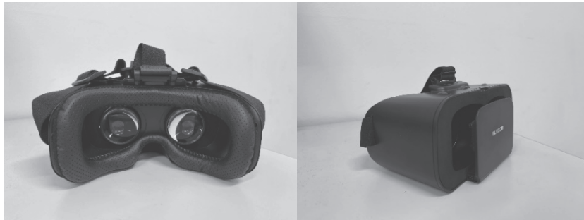
写真2 本研究で使用したVRゴーグル：スマホの画面を利用してVR映像を提示するため、安価にVR映像を視聴できる。
