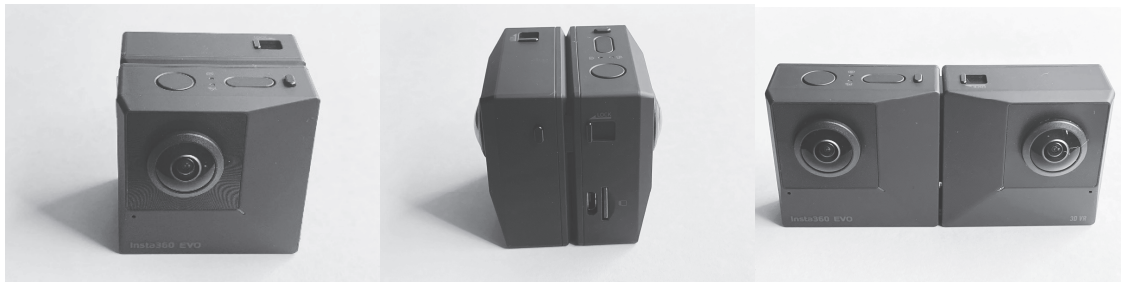
写真1 本研究で使用したInsta360 EVO：本体を折りたたんで2台の魚眼レンズ互い違いの方向に向けると360°のVR動画が撮影できる（左側と中央）。また本体を開いて2台の魚眼レンズを同方向に向けると瞳孔間距離65mmのVR180立体映像が撮影できる（右側）。
